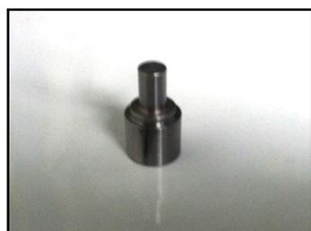
**Doigt de verrouillage fixation**
