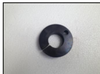
**Bague d'arrêt tube**
