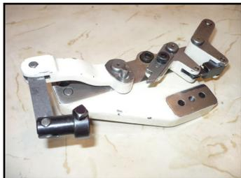
**Mécanisme de déclenchement**
